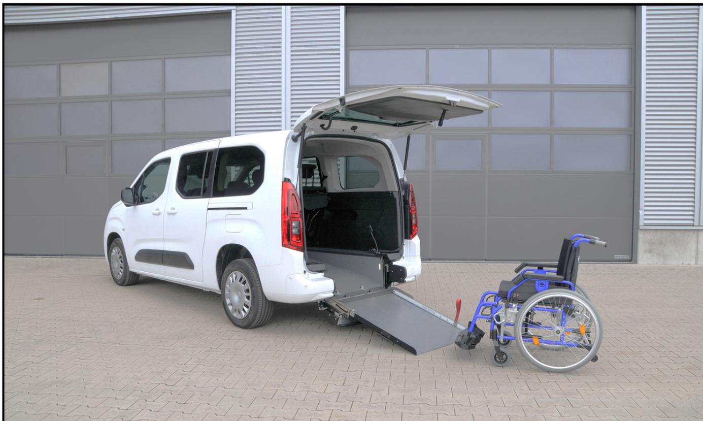
Il veicolo con pianale posteriore ribassato con rampa di accesso antiscivolo consente un facile ingresso alla carrozzina manuale ed elettrica.
