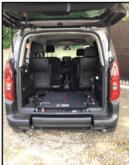
Il sistema di chiusura della rampa EasyFlex in assenza del disabile a bordo consente l'utilizzo del vano bagagli come in origine.
